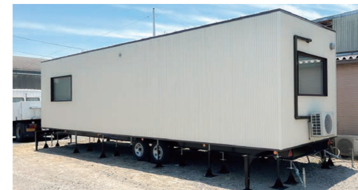
基準緩和認定を受け、かつ特殊車両の通行許可を受けたトレーラーハウス
