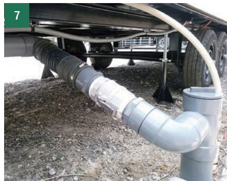
7 排水管の接続方法が工具無しで着脱できる方式であること。
