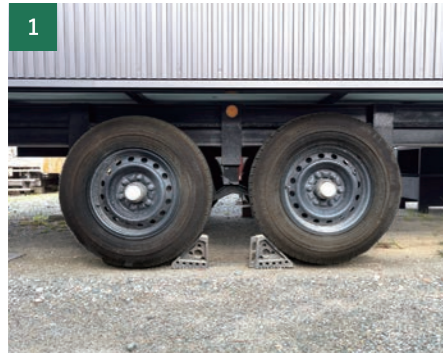
1 車輪が取り外されていないこと。また車輪が走行可能な状態に保守されていること。
