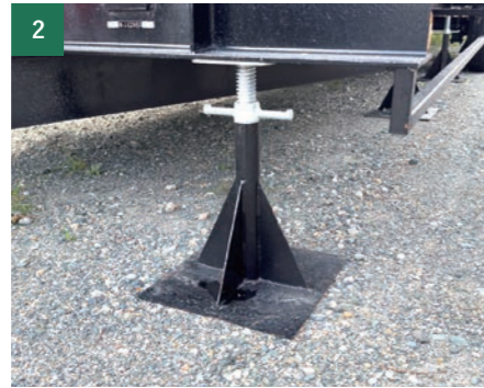
2 車輪以外のもので地盤上に支持されている場合、その支持構造体が工具無しで取り外しができること。
