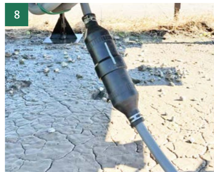
8 電気配線の接続方法が工具無しで着脱できる方式であること。
